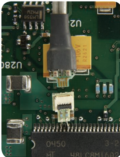
InfiniiMax ZIF tip soldered on board
